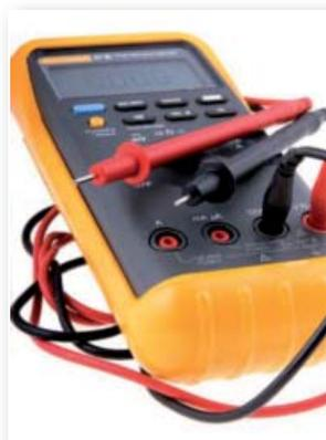
Le multimètre est sûrement l'instrument le plus utilisé par tous les professionnels de l'électricité. Peu de personnes sont au courant qu'il existe 4 catégories de multimètres. Une sélection adéquate est un critère de sécurité important. En d'autres mots : la plupart mettent leur sécurité en péril presque chaque fois que le multimètre est utilisé, car celui-ci peut être inadéquat pour l'utilisation.
